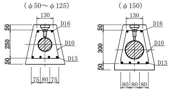
標準構造図 (左L型平面図)
