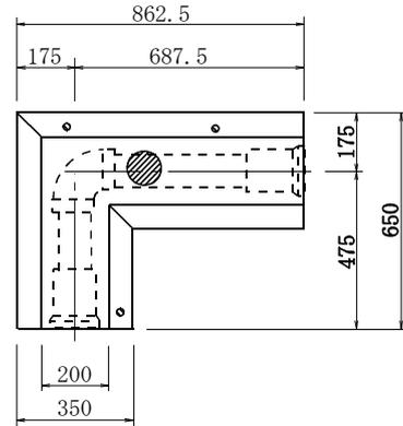
標準構造図 (左L型側面図)
