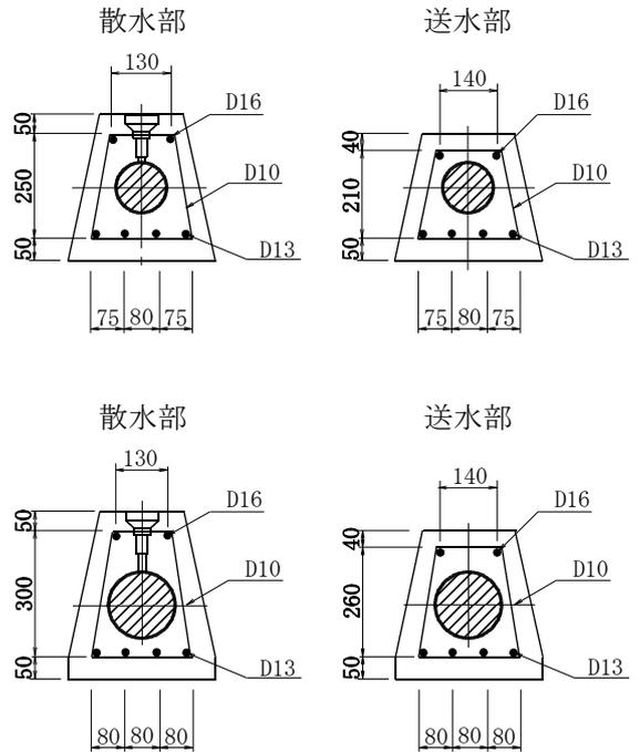
標準構造図 (左L型平面図)
