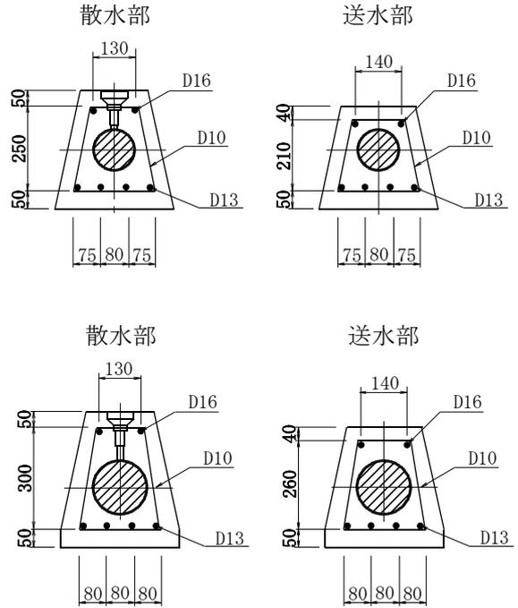
標準構造図 (T型平面図)
