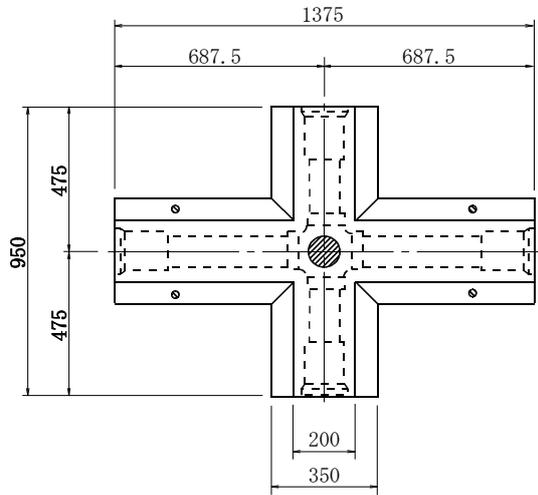
標準構造図 (クロス型側面図)
