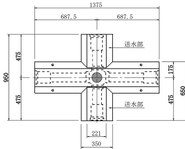
標準構造図 (クロス型側面図)
