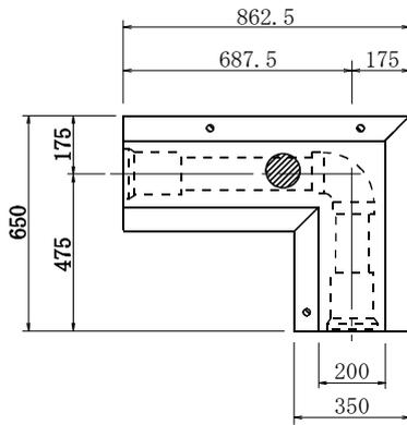
標準構造図 (右L型平面図)
