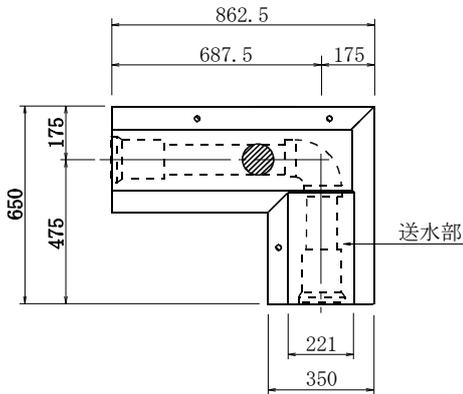
標準構造図 (右L型平面図)
