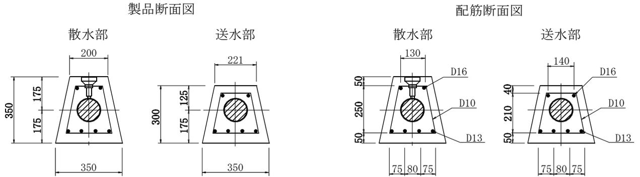
標準構造図 (クロス型平面図)
