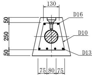
標準構造図 (クロス型平面図)
