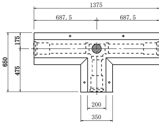
標準構造図 (T型側面図)
